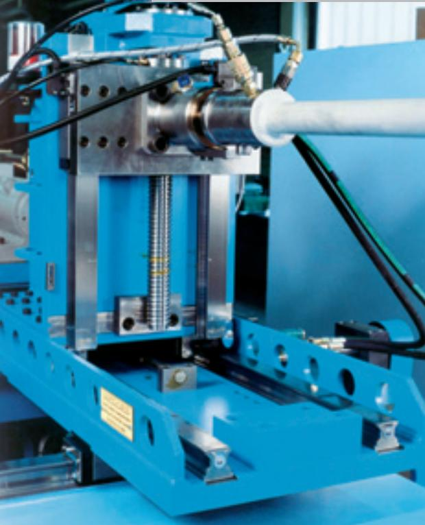
Los husillos como elementos de accionamiento en tres ejes ponen en movimiento, por ejemplo, las herramientas de una curvadora de tubos. Los movimientos se guían con la más elevada precisión a través de patines de rodillos sobre raíles. Nuestros husillos de bolas transforman la rotación de los servomotores en movimientos de traslación precisos. Las diversas formas constructivas, tamaños, inclinaciones y clases de precisión se fabrican para las aplicaciones más variopintas.
