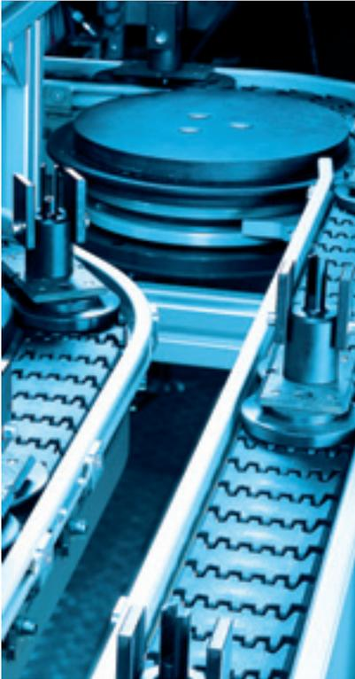
Si necesita un sistema de transporte que desplace las piezas tanto vertical como horizontalmente, y que además almacene y posicione, tiene a su disposición nuestros sistemas de transporte por cadenas. Con el amplio sistema modular, disponible en anchuras de sistema de 65 a 320 mm, podrá realizar sus tareas específicas de transporte – como en este ejemplo para la fabricación de pequeños motores – de forma especialmente económica.
